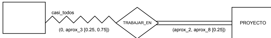
Figura 8: Gráfico imponiendo dos restricciones difusas sobre el mismo arco: Restricción de Participación difusa y Restricción de Cardinalidad Difusa con notación (min, max).
